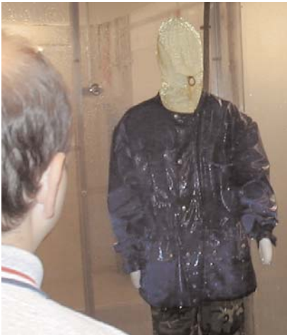
Eine Gore-Tex Jacke wird im Regenturm auf Dichtheit getestet
